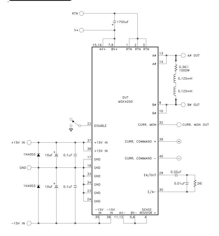
TYPICAL TEST SCHEMATIC
