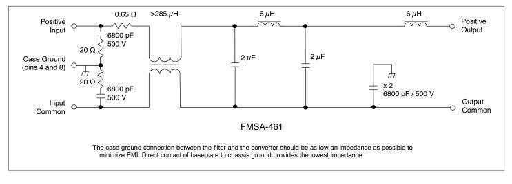
FIGURE 1: FMSA SCHEMATIC - TYPICAL VALUES
