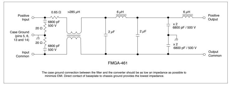
FIGURE 4: FMGA SCHEMATIC – TYPICAL VALUES
